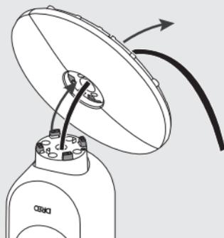
Fissare la base alla parte inferiore del ventilatore.
