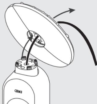
Acople la base a la parte inferior del ventilador.
