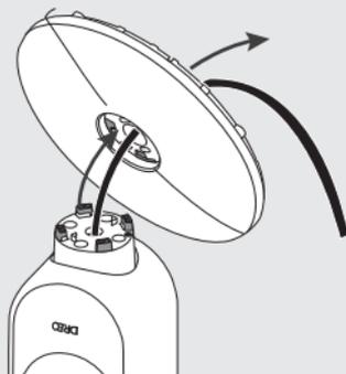
Bringen Sie die Basis an der Unterseite des Lüfters an.
